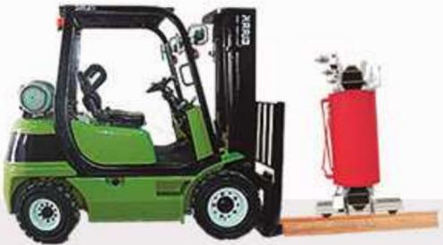
El transformador siempre debe ser transportado y manipulado en posición vertical de tal forma que las conexiones, terminales primarios, secundarios y demás accesorios no estén en contacto con ninguna parte del montacargas.
